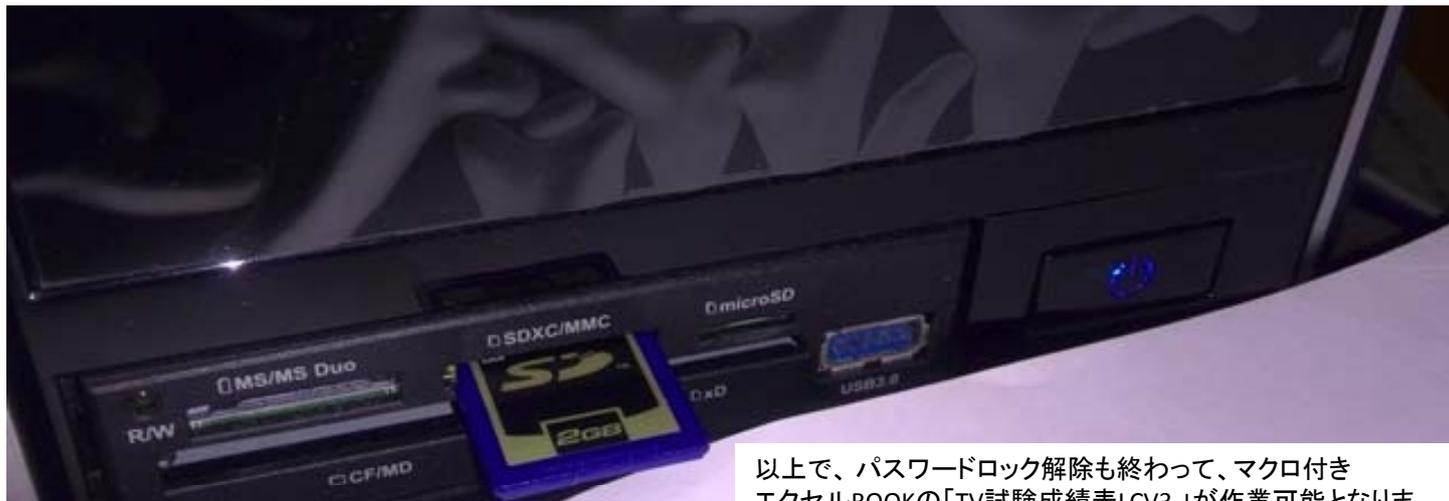
以上で、パスワードロック解除も終わって、マクロ付きエクセルBOOKの「TV試験成績表LCV3」が作業可能となりましたので、それでは早速作業手順の説明に移っていきます。まずは、マスプロ製レベルチェッカーの多チャンネルの測定データが入ったSDカードをチェッカーから抜き、パソコンのメディアSD入力に挿入します。一方、エクセルBOOKの「TV試験成績表LCV3」では、データ転載ワークシートに移動して下さい。
